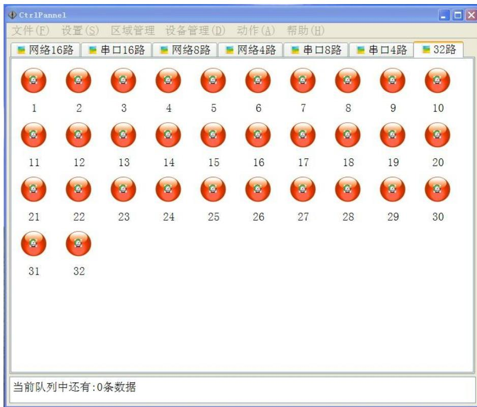
输入输出产品，1-16路代表1-16路继电器输出，17-32路代表1-16路输入。设备名称可自定义，方便客户使用。控制软件请在官网下载。
